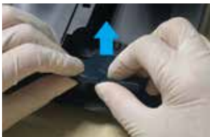
Odpojte od analyzátoru malý a velký panel.
