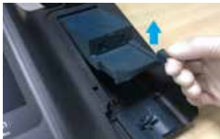
Odklopte držák puřrovacího kitu.
